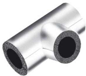
Пример: для покрытия трубы диаметром 76 мм (A-B) и толщиной теплоизоляции 32 мм, следует выбрать тройник размерами 140x140.
