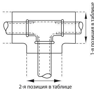
К примеру: диаметр трубы - 76 мм, толщина изоляции - 32 мм.  $32 \times 2 = 64 + 76 = 140$ . Необходимый размер тройника - 140 x 140.
